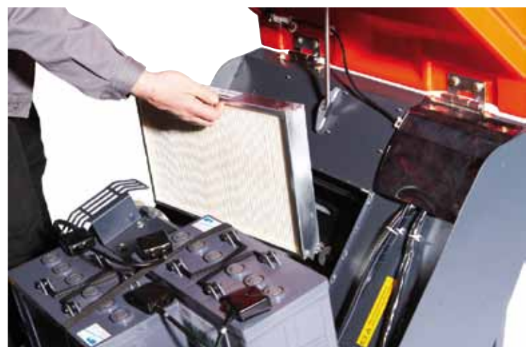
Das „Take-it-Easy-Behältersystem“ erlaubt eine komfortable Entleerung (l.). Auch der Filterwechsel ist unkompliziert (r.).
