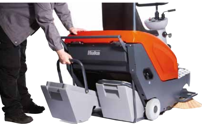
Das „Take-it-Easy-Behältersystem“ erlaubt eine komfortable Entleerung (l.). Auch der Filterwechsel ist unkompliziert (r.).
